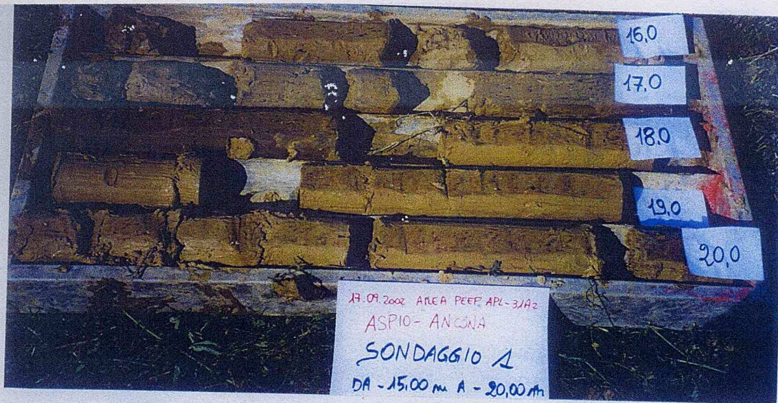
FOTO 7: Sondaggio S.1 da -15,0 m a -20,0 m da p.c.
