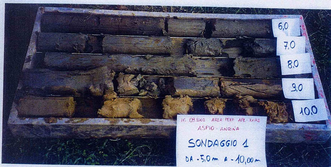
FOTO 5: Sondaggio S.1 da - 5,0 m a - 10,0 m da p.c.
