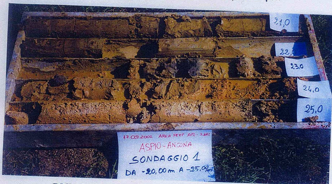
FOTO 8: Sondaggio S.1 da -20,0 m a -25,0 m da p.c.
