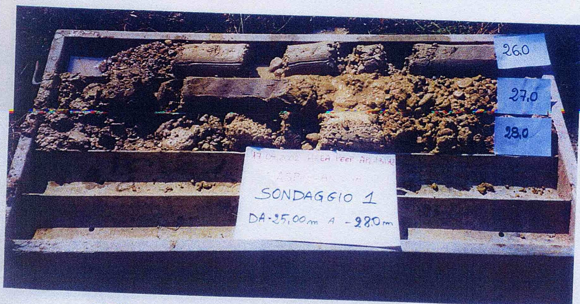
FOTO 9: Sondaggio S.1 da -25,0 m a -28,0 m da p.c.
