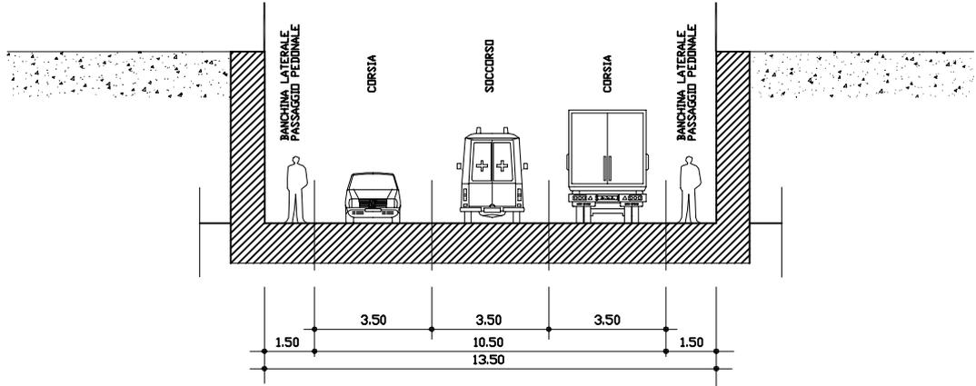
SEZIONE TIPO IN RAMPA
