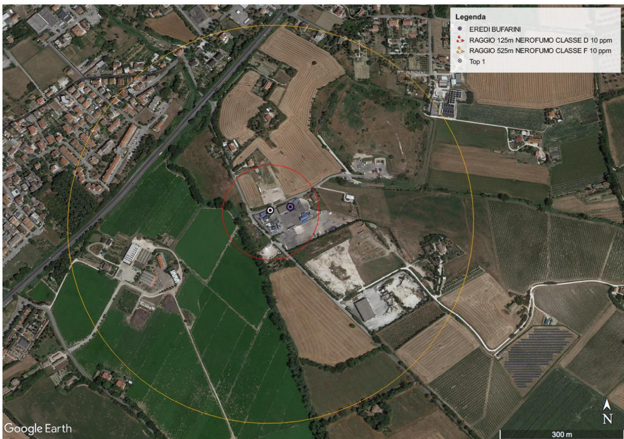
Figura 7: Aree di inviluppo delle ricadute al suolo di Nerofumo da incendio del Top Event 1.
